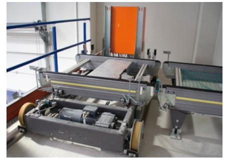
Zentraler Querverteilerwagen mit geringer Bauhöhe für die Ein- und Auslagerung. Low-height central transfer car for storage and retrieval.
