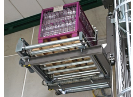
Nach der Identifizierung wird die Ladeeinheit platzsparend durch einen Vertikalförderer auf die Einlagerebene transportiert. After identification the vertical conveyor forwards the load units to the storage level.
