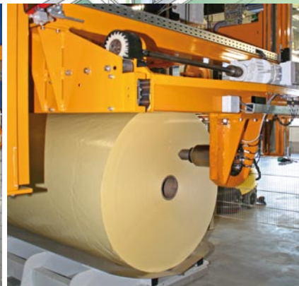
Spezielle Dornaufnahme im Rollenportal zum schonenden Transport des sensiblen Rollenmaterials.
