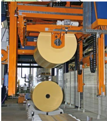
Rollenportal mit Pufferplätzen für die Produktionsversorgung.
