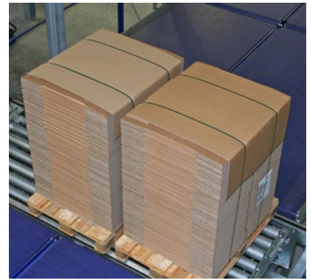
Pärchentransport auf Rollen- und Kunststoffkettenförderern.
