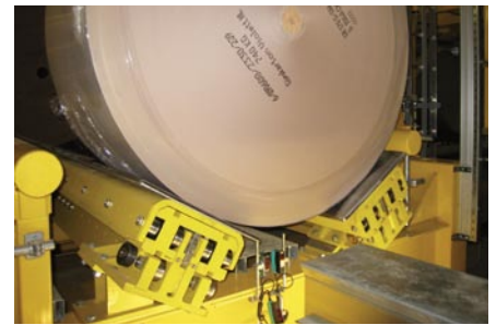
Spezielle RBG-Teleskopgabeln für besonders schonenden Transport der Rollen. Special S/R telescopic forks secure careful and gentle roll transport.
