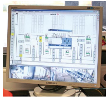
Hi LIS Anlagenvisualisierung in Echtzeit mit Kameraüberwachung. Hi LIS real-time CCTV plant visualization.
